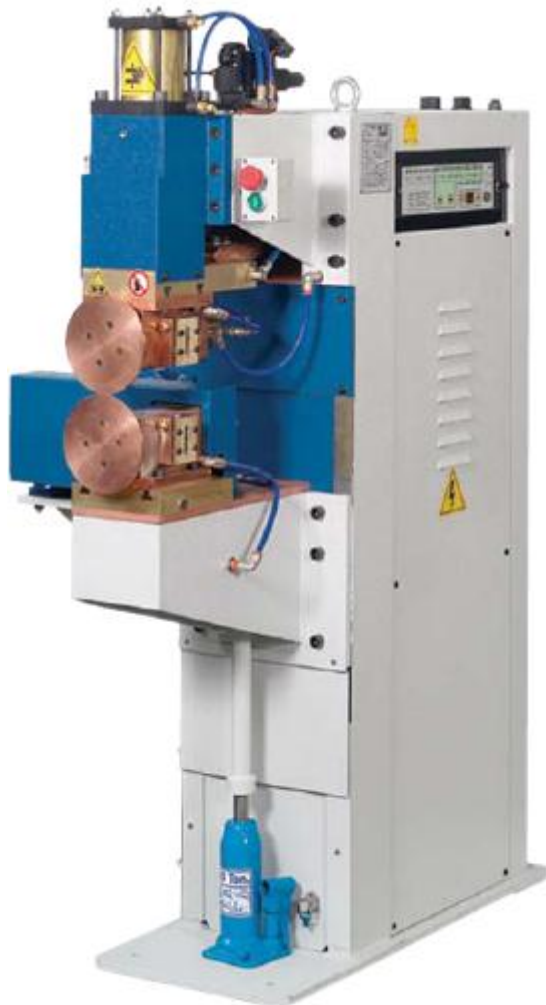
RT 80/ RT 100 Effekt: 60 – 150 kVA Svetshast: 0,6 – 5 m/min Godstjocklek: 1,2+1,2 – 3+3 mm
