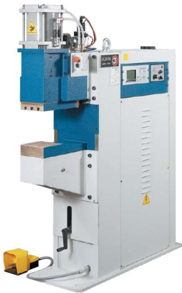
PPN 3F CC: 3-fas DC Transformator
